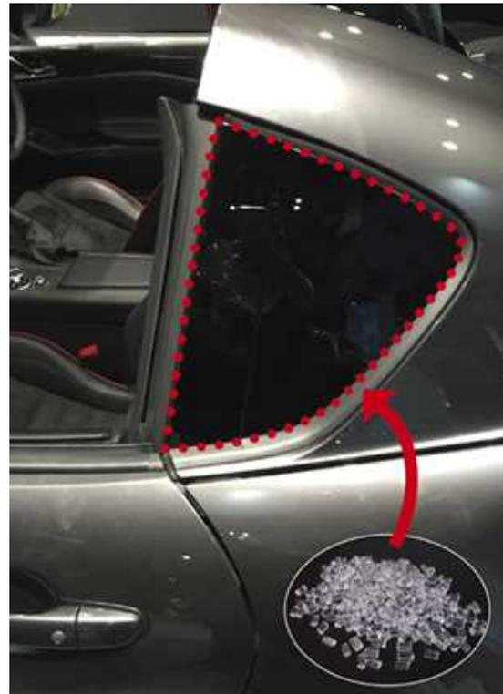
自動車の軽量化という流れの中で、三菱ケミカルの新素材が外装部材に採用された足跡は大きい [拡大画像表示](#)
